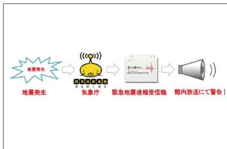
緊急地震速報システムを導入し、地震による大きな揺れが到達する前に館内で働く人へ全館放送で注意を促します。
