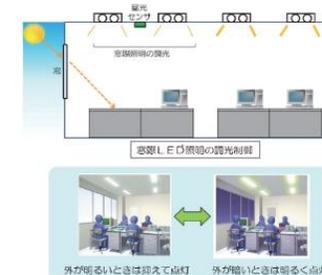
事務所窓側の照明を昼光センサーにより制御し、自然光利用による省エネを図ります。
